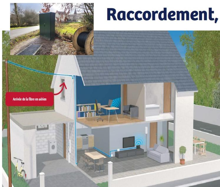
Le raccordement final du logement est la dernière étape avant de pouvoir réellement profiter de la fibre. Il consiste à faire passer un câble de fibre optique en provenance de la rue jusqu'à l'intérieur du logement ou du local professionnel et à installer une prise optique sur laquelle sera branchée la box de l'opérateur. **Généralement, l'installateur suit le même chemin que celui du réseau téléphonique existant.**
